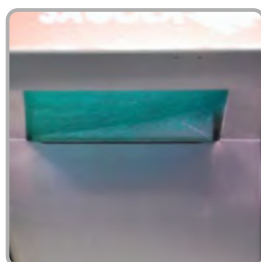
Auto-aspiración de vapores de disolvente.
